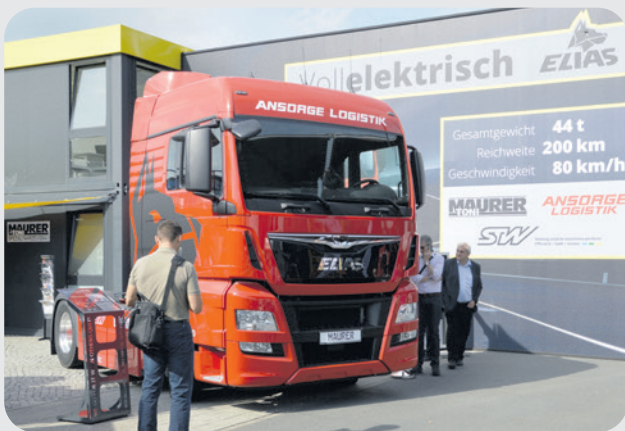
Elektrofahrzeug ELIAS des Herstellers MAN mit zwei Elektro-Synchronmotoren mit jeweils 140 kW und zwei Batterietrögen mit zusammen 200 kWh.
