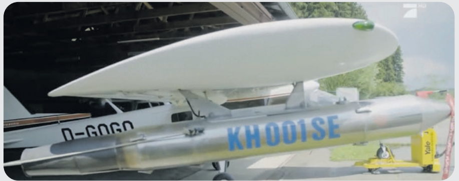
An den Tragflächen der zweimotorigen Propellermaschine sind Tanks/«Generatoren» angebracht, die den «Impfstoff» enthalten – eine spezielle Silberiodid-Aceton-Lösung. Wo sind eigentlich die Umweltschützer, die gegen das Versprühen dieser Chemikalie protestieren?
