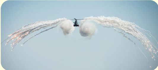
Ein rumänischer Helikopter bringt «Düppel»-Wolken aus hauchdünnen chemischen Fasern aus, mit denen gegnerische Radargeräte getäuscht werden können.
