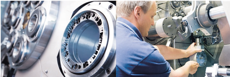
Abb. 8.13 Schnittstelle zwischen der z-Pinole der Kreuzschlitten und den Werkzeugköpfen bzw. Bearbeitungseinrichtungen bei der Baureihe SCX (links), Montage eines Werkzeugkopfs (rechts) [Schu10]
