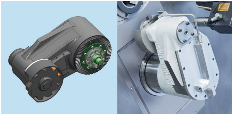
Abb. 7.15 Prinzipaufbau einer Bearbeitungseinrichtung zum Schlitzfräsen am Werkstückumfang (links) sowie Realbild der gleichen Einrichtung in Bestückung mit einem Mehrkantdrehwerkzeug (rechts). [Quelle: Schütte]
