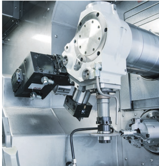
Abb. 5.27 Rückseitenbearbeitungsstation einer SC9-32 mit Einrichtungen zum Scheiben- und Gewindefräsen [Schu16a]
