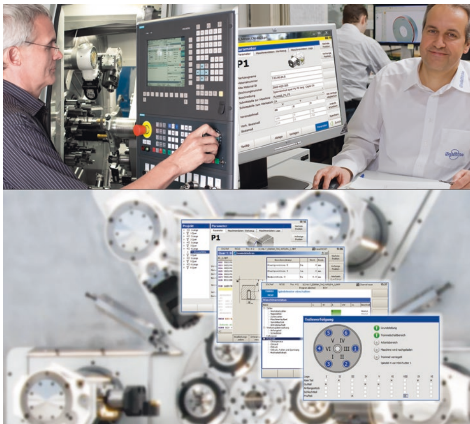
Abb. 11.3 Arbeitsplätze (oben) und Bedienoberflächen (unten) für die Programmierung und Einrichtung eines Mehrspindel-Drehautomaten [Schu16a, Schu17]
