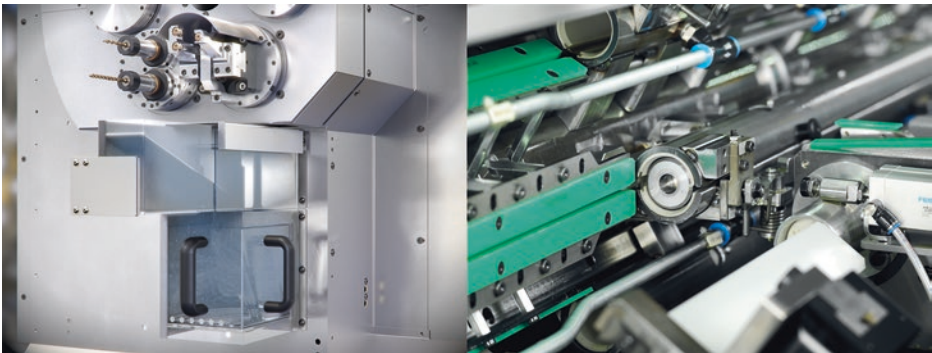
Abb. 9.3 Greiferzange für das Stangenvorziehen auf der Längslage I der SCX mit Reststück-abwurf [Schu16a] (links) und Stangenrückseite mit Plandrehung und Bohrung für das zentrierte Vorschieben der Materialstange beim Lader MBL40-6 [Inde16] (rechts)
