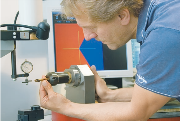
Abb. 8.7 Voreinstellung eines Bohrers außerhalb der Maschine [Schu10]
