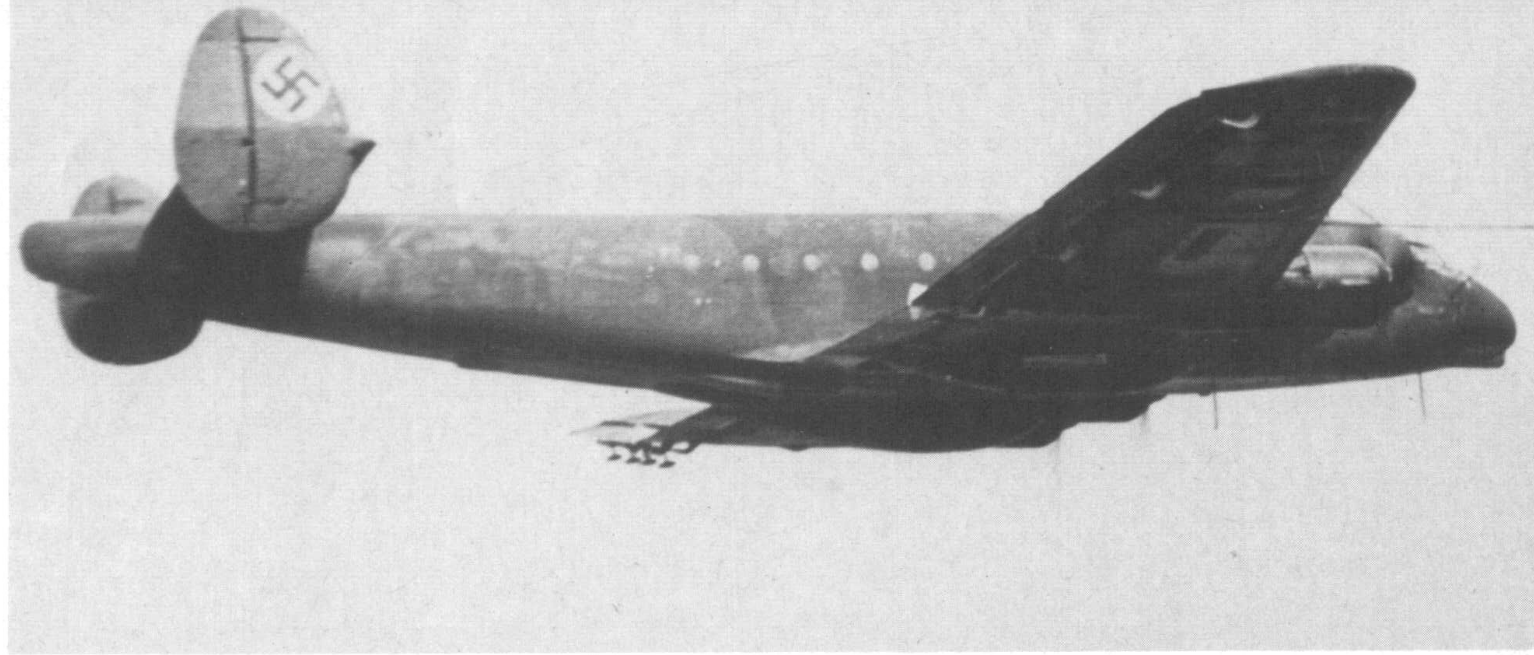
Ju 90 V 5, ex D-AEDS, "Ersatz-Preußen", hatte noch den Rumpf und die Flächen der Ju 90 B, aber bereits Leitwerk und Triebwerke der ersten Ju 290.
