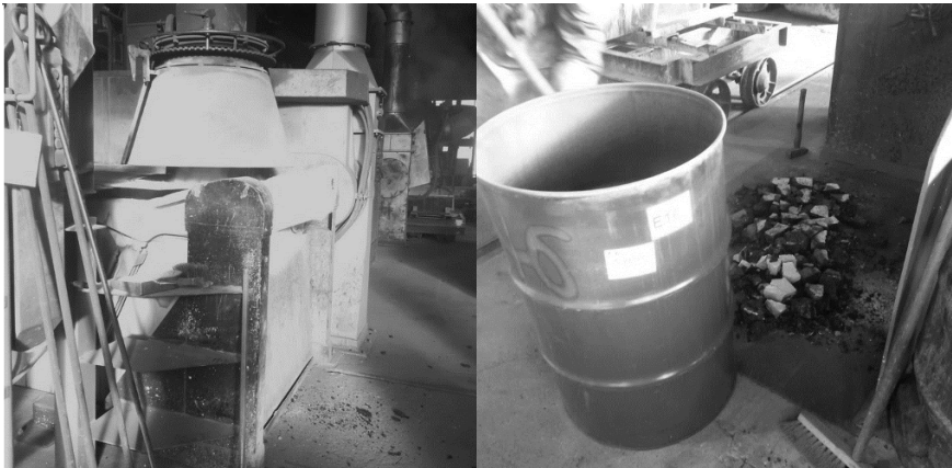
Abbildung 7.10: Das Einschmelzen der Probe in der „alten Präparation“. Eigene Aufnahmen. © Stefan Laser 2019. All Rights Reserved. Links: ein aktiver Schmelztiegel. Rechts: der eingeschmolzene und nunmehr zerbrochene „Stein“.
