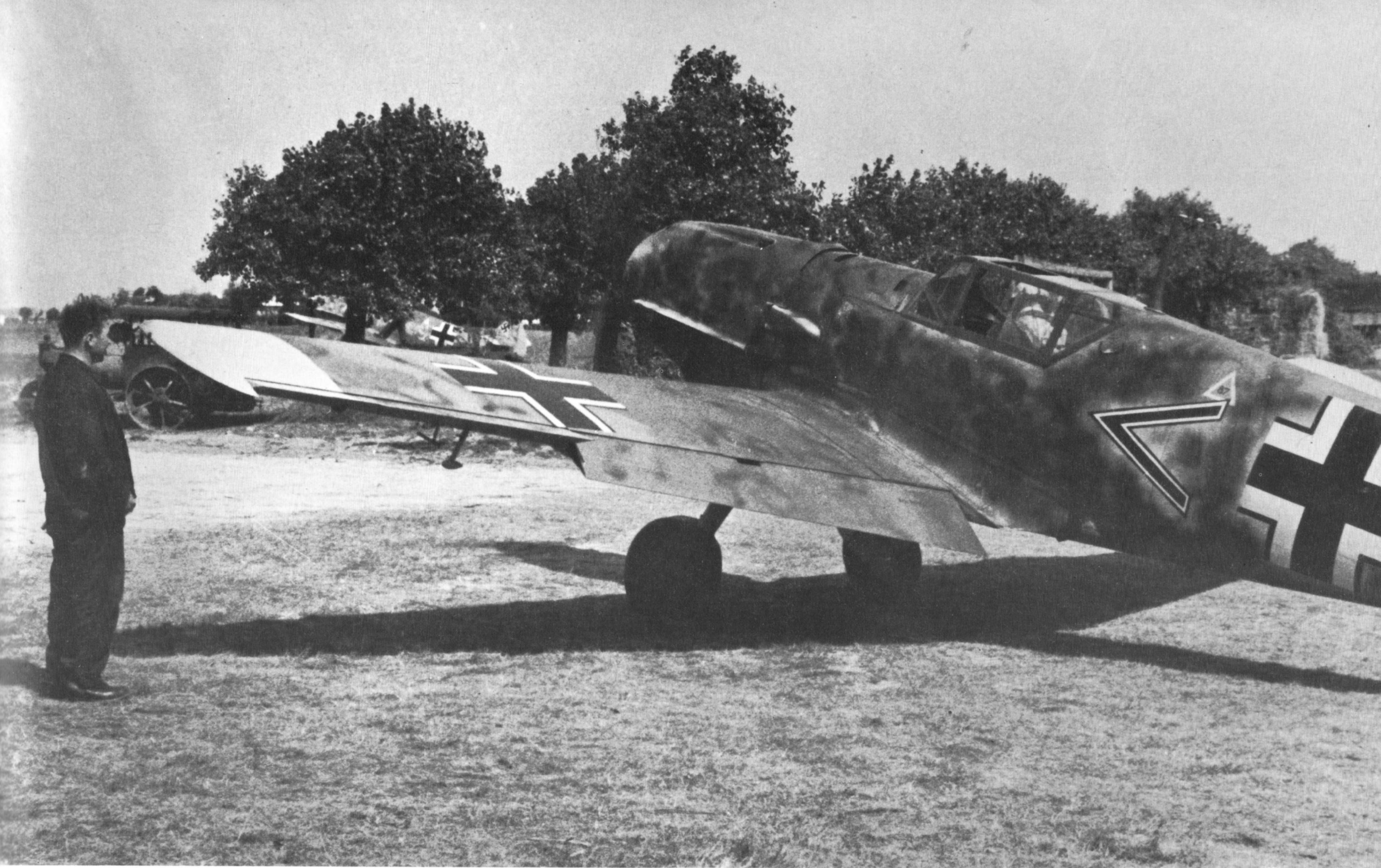
Die letzte äußere Veränderung der E-Reihe entstand durch Verwendung glatter Kabinenabdeckungen. Auffällig ist in diesem Zusammenhang, daß die Panzerung der Frontscheibe wieder entfallen war.
