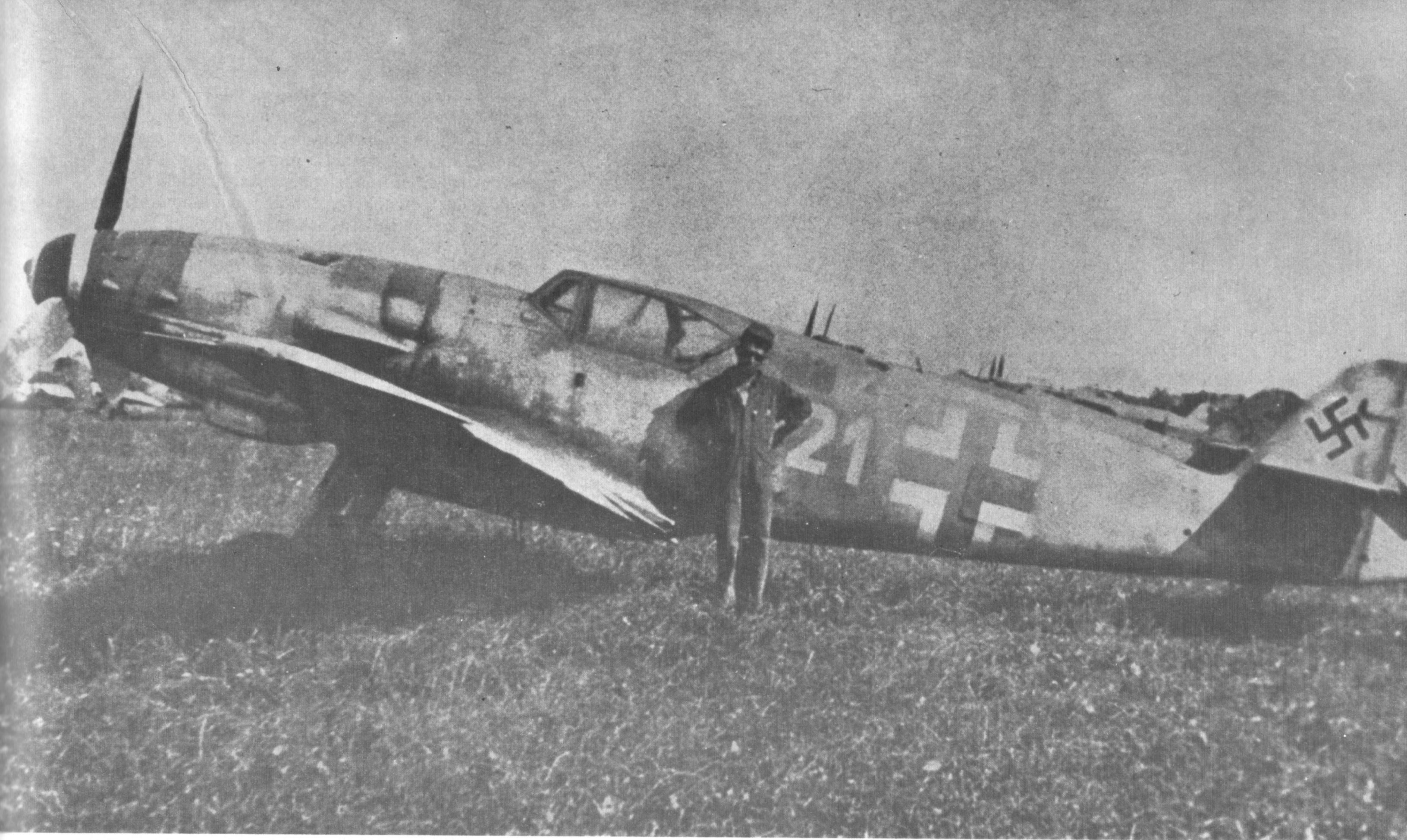
Die Me 109 auf dieser Abbildung kann nicht eindeutig angesprochen werden. Entweder handelt es sich hierbei um ein Muster aus der G-10 oder der G-14 Reihe. Beide (bei der G-10 teilweise) hatten gegenüber den vorhergegangenen Versionen die gleichen äußeren Veränderungen: Das modifizierte Seitenleitwerk und die "Galland-Haube".
