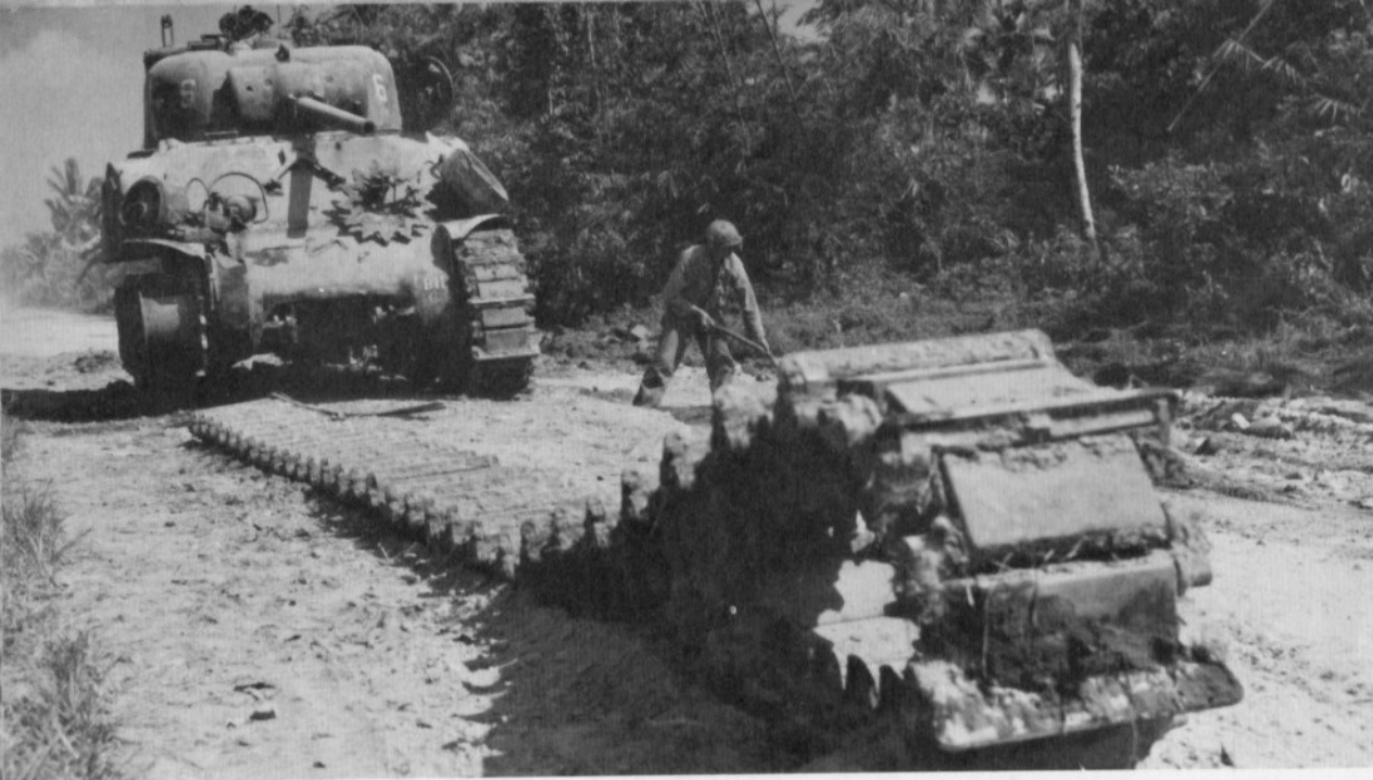
M4 mit zusammengesetzter Wanne der 81. Infanteriedivision auf Angaur (Palau-Inseln), 21. September 1944. Diese Panzer verwenden Stahlketten mit Stollen und besitzen die gepreßten, massiven Laufrollen. Sie gehören zur "B"-Kompanie des Panzerbataillons.
