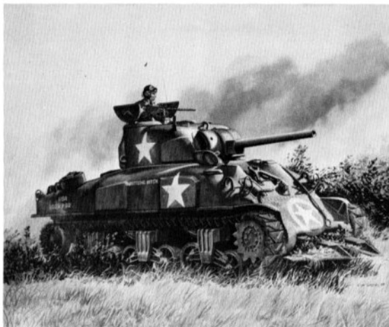
"Battling Bitch", ein M4A1 des 31. Panzerbataillons der 7. US Panzerdivision in Mittelfrankreich. Hier gesehen in der Nähe von Chartres, August 1944, trägt er noch die Cullin Hedgerow-Ausrüstung, die während des Normandie-Feldzuges angebracht worden war.
