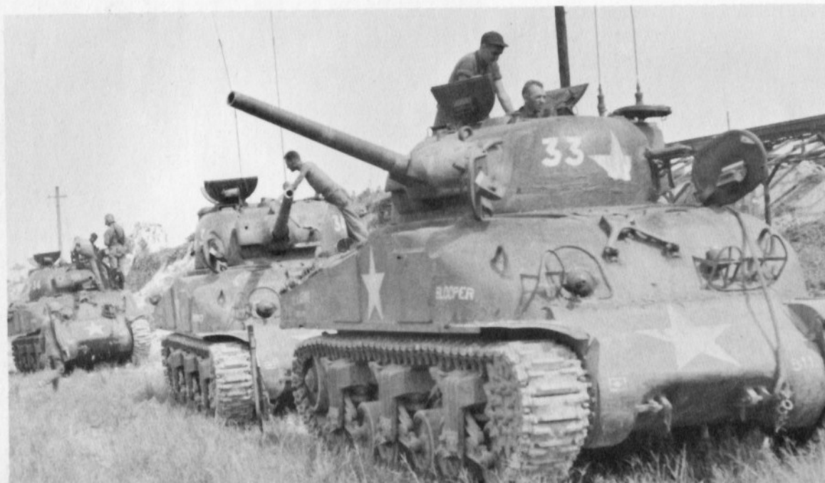
M4 mit zusammengesetzter Wanne der 81. Infanteriedivision auf Angaur (Palau-Inseln), 21. September 1944. Diese Panzer verwenden Stahlketten mit Stollen und besitzen die gepreßten, massiven Laufrollen. Sie gehören zur "B"-Kompanie des Panzerbataillons.
