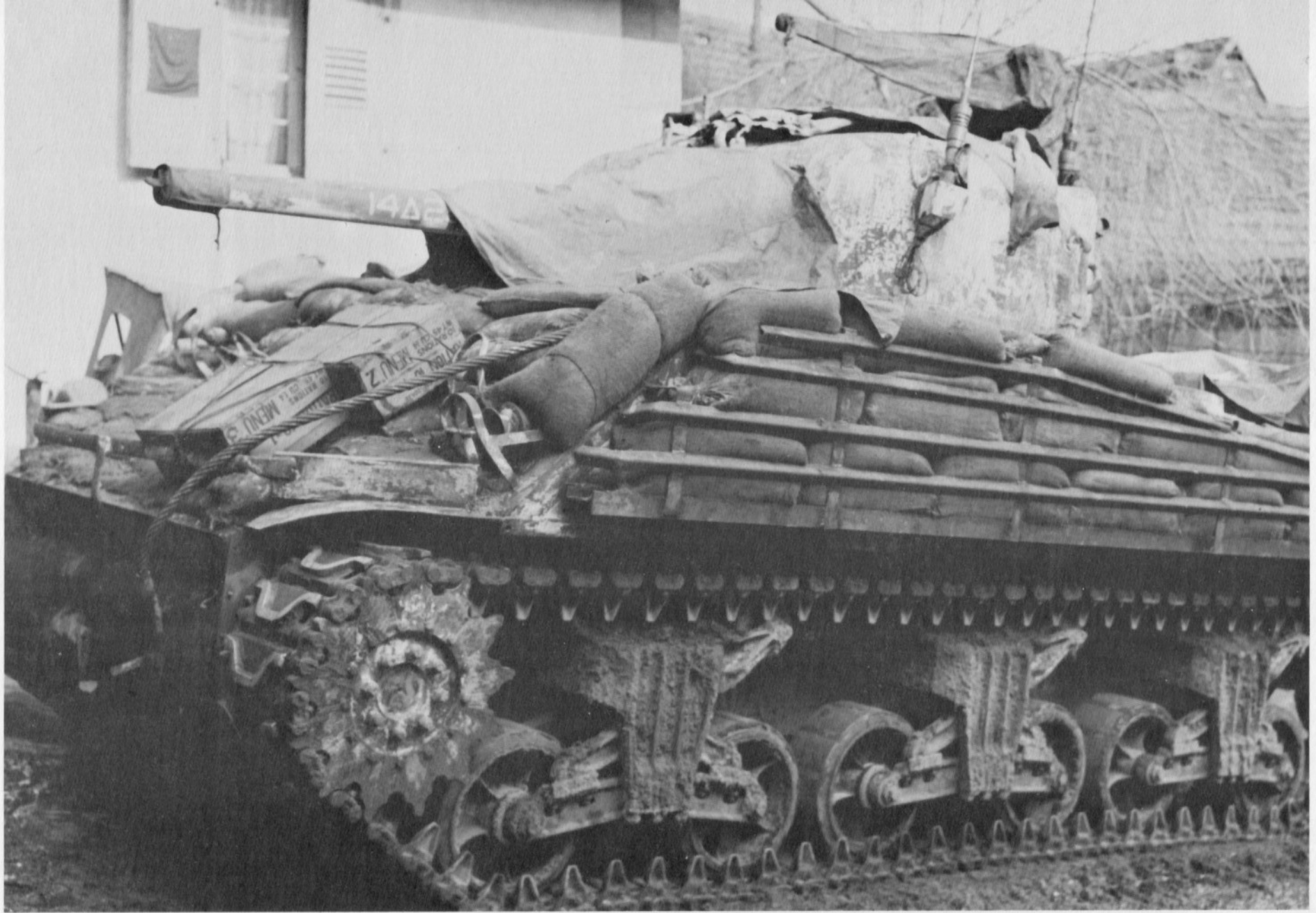
Dieser Panzer des 25. Panzerbataillons der 14. Panzerdivision wurde am 11. Februar 1945 in Hüttendorf fotografiert. Sandsäcke zum Schutz gegen deutsche Panzerabwehrraketen wurden um die gesamte Wanne gelegt. Unter den Sandsäcken befindet sich die neue 47 o -Bugplatte.
