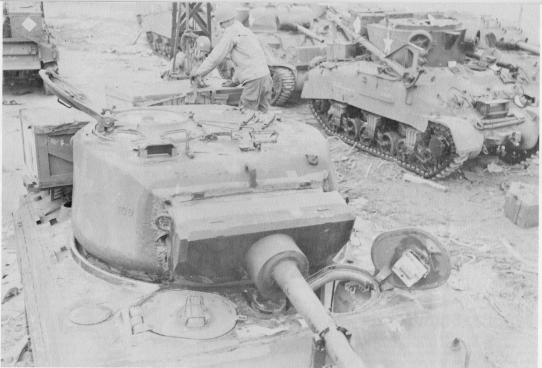
Aufgenommen in einem Panzerdepot in Cherbourg (Frankreich); dieses Fahrzeug ist ein M4A3E2-Sturmpanzer. Dieser Spezialpanzer wurde in begrenzter Stückzahl hergestellt und besaß eine Panzerung bis 17,8 cm Stärke. Die hervorragende Draufsicht zeigt alle Einzelheiten des einzigartigen Turmes des 'E2. Der M4A3E2 war mit einer Standard-M3-Kanone bewaffnet. Beachtenswert die 17,8 cm dicke, aufgesetzte Blende und der breitere Turm mit 15,2 cm dicken Seiten. Die 2,5 cm starke Turmplatte war auf dem gegossenen Turm aufgeschweißt.
