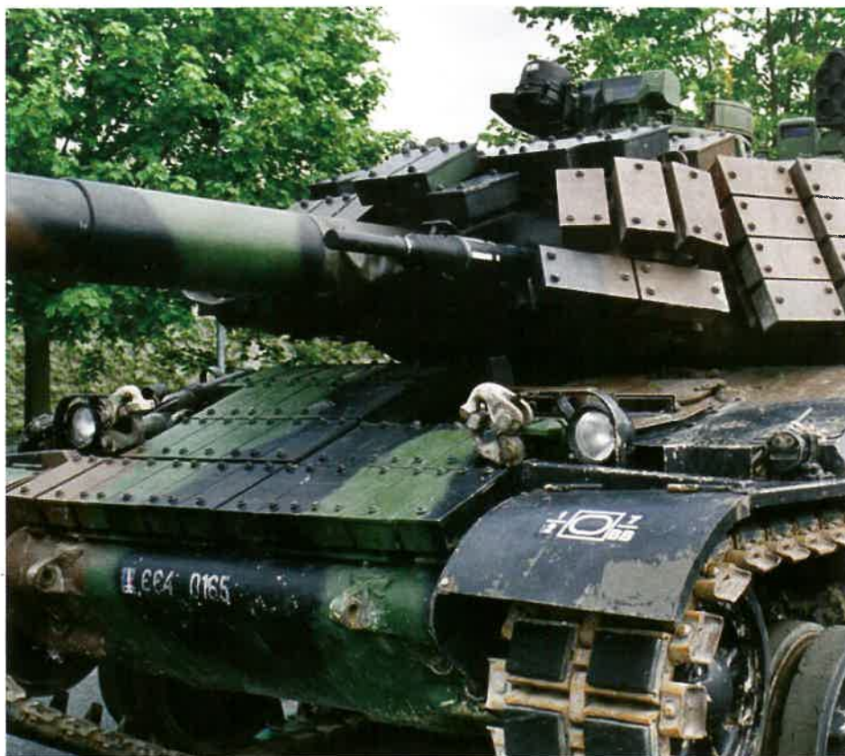
AMX-30B2 Brennus o numerze 664 0165, należący do 501e-503e RCC podczas publicznej prezentacji sprzętu używanego przez armię francuską. Konkretnie ten pojazd wprowadzony został do służby w 1996 r. Wyposażono go w silnik Mack E9 oraz kamerę termowizyjną DIVT-18 [Fot. Zurich 2D]
