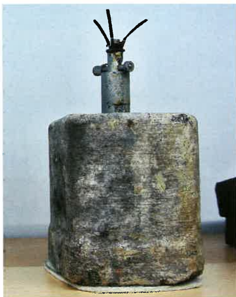
Abwehrmine Beton z zapalnikiem naciskowym S-Minenzünder 35 eksponowana na wystawie Muzeum Saperskiego Explosive w Dąbrowce. Produkcję tego rodzaju broni uruchomiono w chwili, gdy klęska III Rzeszy była już przesądzona. Jako korpusy wykorzystywano różnego kształtu odlewy betonowe, często pozbawione już zatopionych wewnątrz elementów metalowych [Fot. Ł. Gładysiak]
