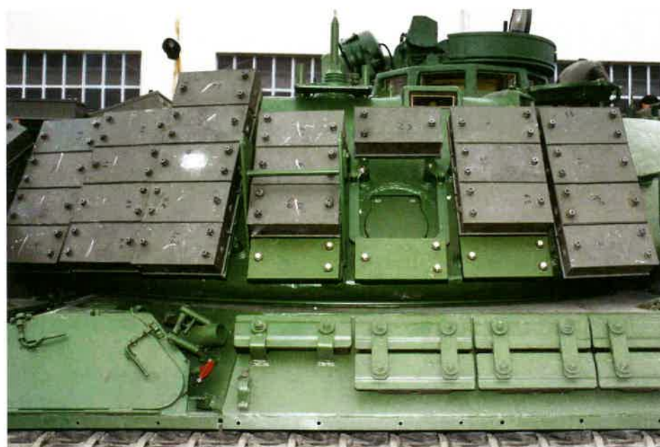
Większa część przedniej oraz bocznych powierzchni wieży czołgu AMX-30B2 Brennus uzupełniona została w pancerze reaktywne. Przewożone na ścianach zewnętrznych zasobniki na wyposażenie dodatkowe zostały przeniesione do tyłu oraz na górną płytę przedziału silnikowego [Fot.: Cellule S.T.A.T.]
