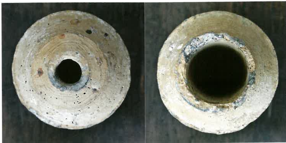
Korpus Stockmine 43/II widok z góry (z lewej) oraz z dołu (z prawej). Wywiercone otwory służyły odpowiednio do montażu zapalnika (góra) oraz ładunku wybuchowego i kołka [Fot. Ł. Gładysiak]
