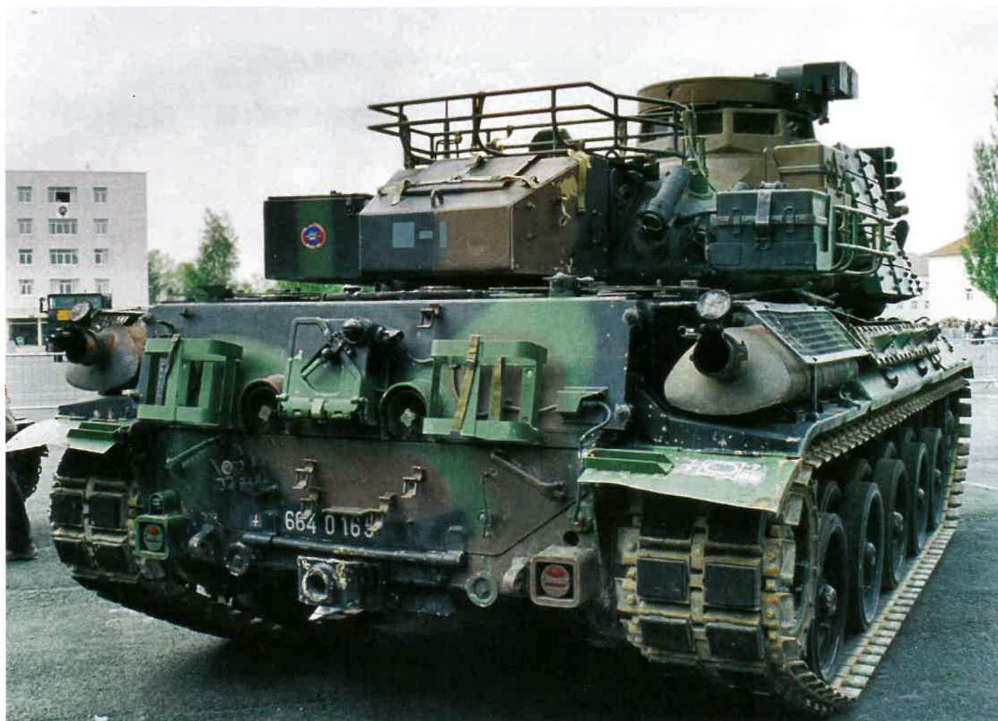
AMX-30B2 Brennus o numerze 664 0165, należący do 501e-503e RCC podczas publicznej prezentacji sprzętu używanego przez armię francuską. Konkretnie ten pojazd wprowadzony został do służby w 1996 r. Wyposażono go w silnik Mack E9 oraz kamerę termowizyjną DIVT-18 [Fot. Zurich 2D]
