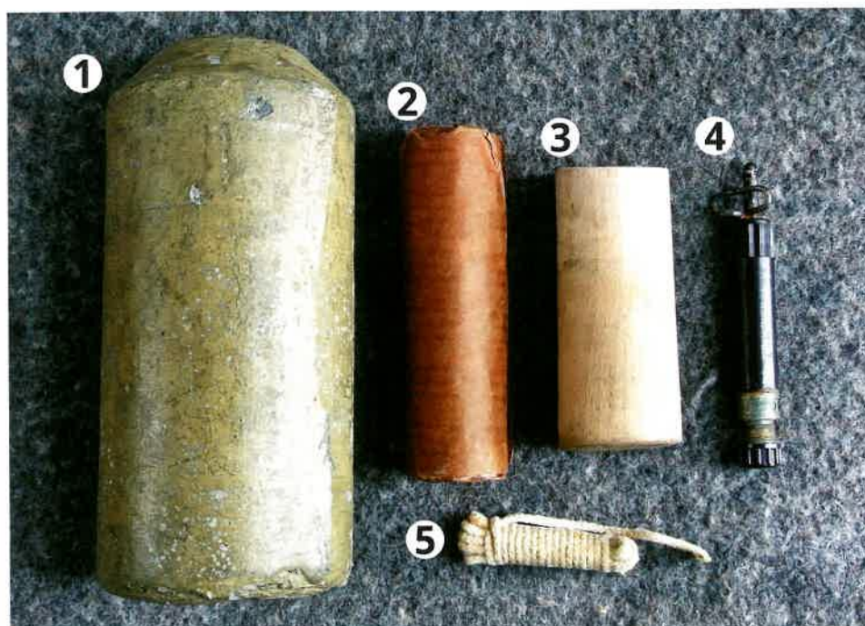
Stockmine 43/II gotowa do uzbrojenia: 1 – betonowy korpus miny, 2 – ładunek wybuchowy Bohrpatrone 28 o masie 100 g, 3 – kulek stabilizujący w wersji skróconej, 4 – zapalnik odciągowy Zugzünder 42 , 5 – sznurek odciągowy. Zbiory Studio Historycznego Huzar w Koszalinie [Fot. Ł. Gładysiak]
