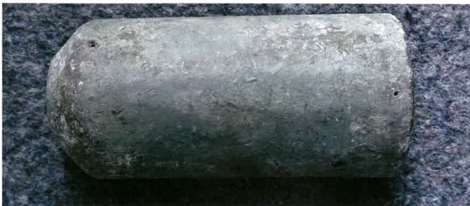
Pochodzący ze zbiorów Studio Historycznego Huzar w Koszalinie korpus Stockmine 43/II z zachowaną niemal w całości, oryginalną, stosunkowo rzadko spotykaną, szarozieloną farbą [Fot. Ł. Gładysiak]
