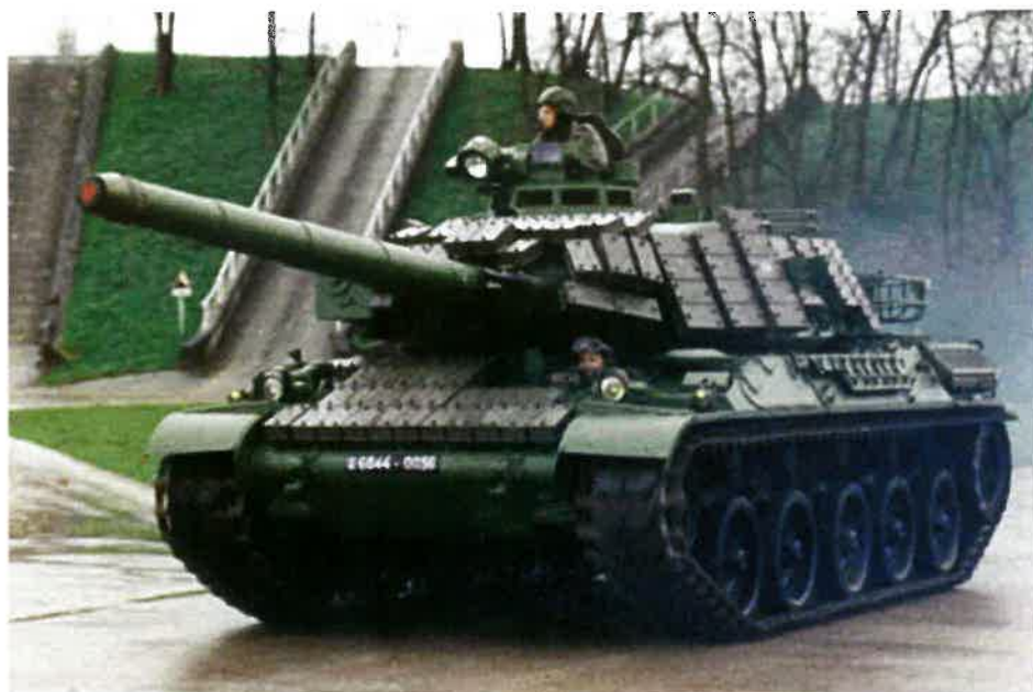
Prototypowy AMX-30B2 Brennus o numerze 6844 0056 podczas prób. Zwraca uwagę jednobarwne, zielone malowanie wozu obowiązujące w armii francuskiej w latach osiemdziesiątych XX w. [Fot. Cellule S.T.A.T.]
