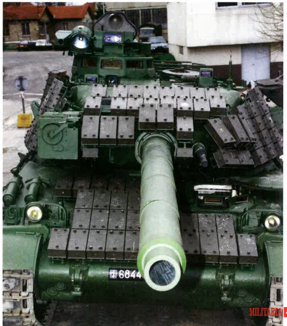
Pancerz czołgu podstawowego AMX-30B2 bez kostek reaktywnych produkcji GIAT. Opisany w artykule model wozu stanowił tymczasowe rozwiązanie wdrożone w chwili, gdy armia francuska oczekiwała na maszyny typu Char Leclerc [Fot. Daniel Eledut]
