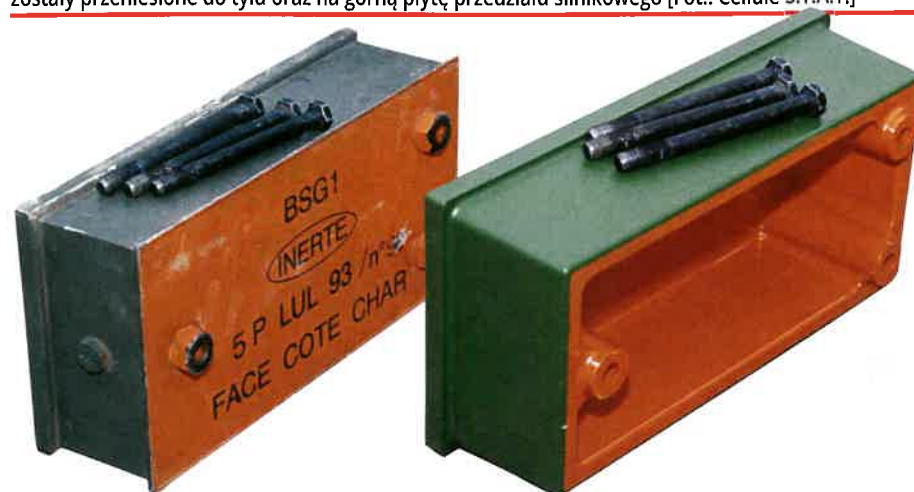
Kostka stanowiąca element pancerza reaktywnego GIAT BS. We wnętrzu każdej umieszczonych było 400 g ładunku wybuchowego. Masa pojedynczej kostki sięgała 12 kg [Fot. Cellule S.T.A.T.]
