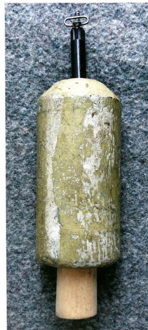
Uzbrojona Stockmine 43/II ze skróconym kółkiem, wykorzystywanym między innymi, gdy mina mocowana była do pnia drzewa [Fot. Ł. Gładysiak]
