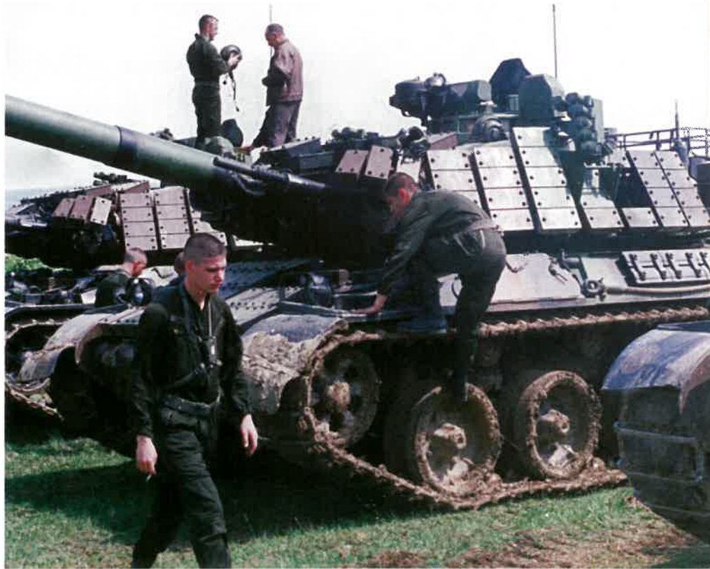
AMX-30B2 Brennus po zakończeniu dnia działań na poligonie. Warto zwrócić uwagę na sposób wsiadania i wysiadania mechanika-kierowcy tego czołgu, utrudniony przez instalację pancerza reaktywnego [Fot. Lionel Gonnet]
