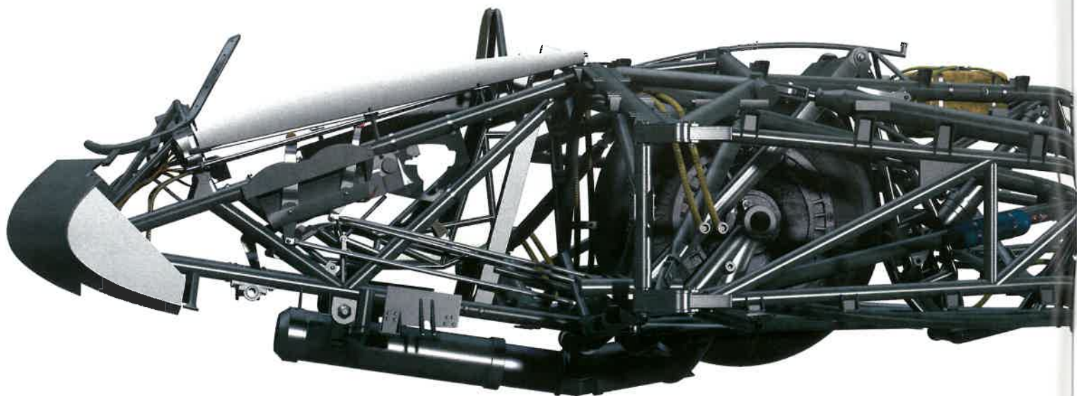
Usytuowanie schowanego koła przedniego w kratownicy kadłuba
