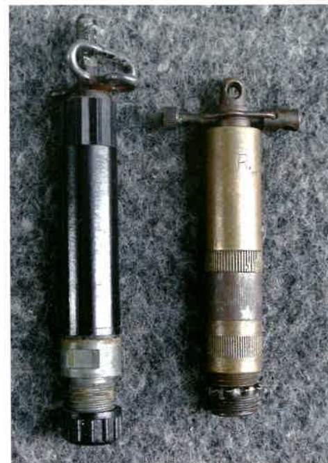
Zachowane w zbiorach Studio Historycznego Huzar w Koszalinie dwa podstawowe modele zapalników odciągowych wykorzystywanych w niemieckich minach betonowych: Zugzünder 42 (z lewej) oraz Zugzünder 35 [Fot. Ł. Gładysiak]
