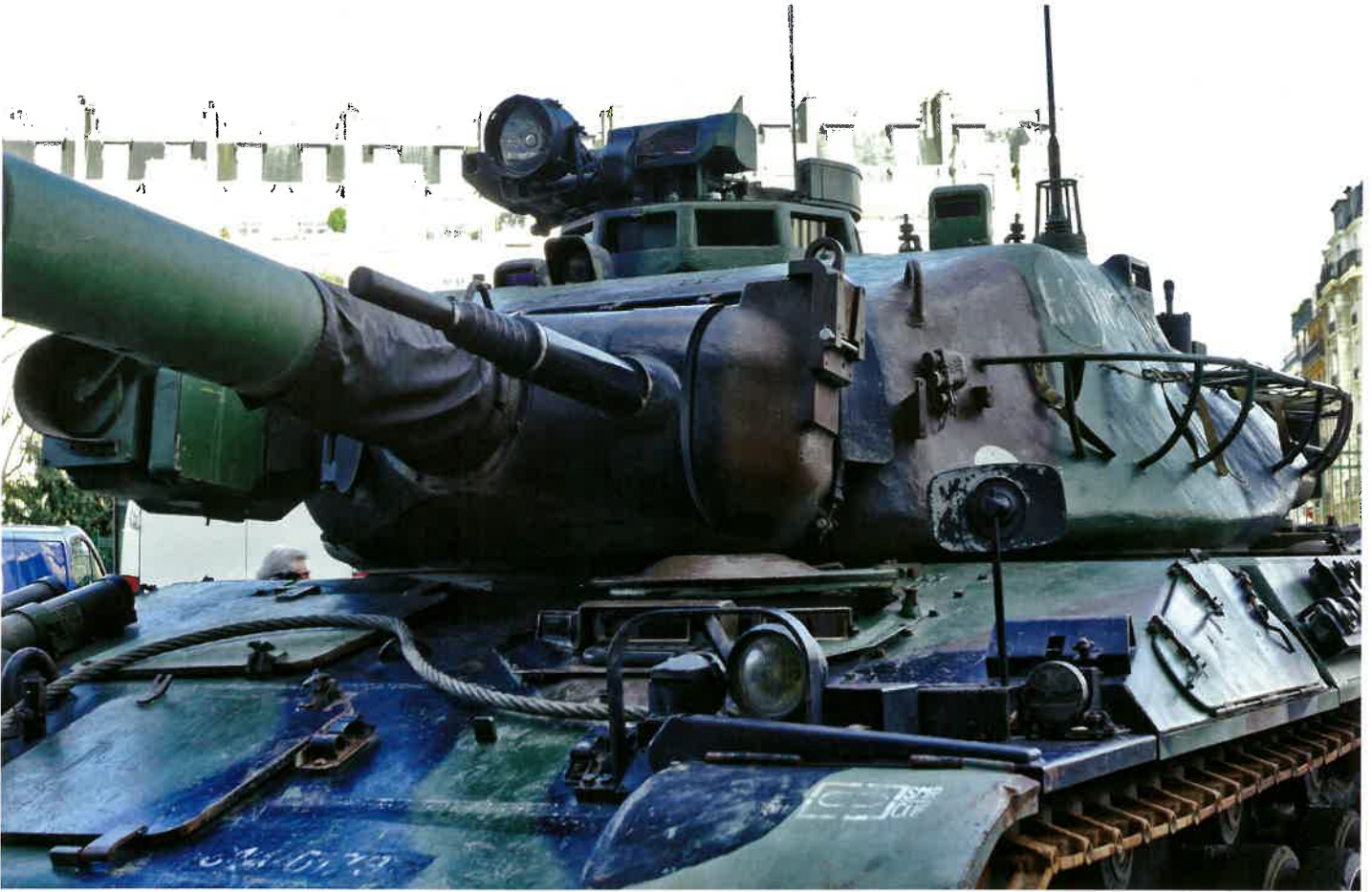
Pancerz czołgu podstawowego AMX-30B2 bez kostek reaktywnych produkcji GIAT. Opisany w artykule model wozu stanowił tymczasowe rozwiązanie wdrożone w chwili, gdy armia francuska oczekiwała na maszyny typu Char Leclerc [Fot. Daniel Eledut]
